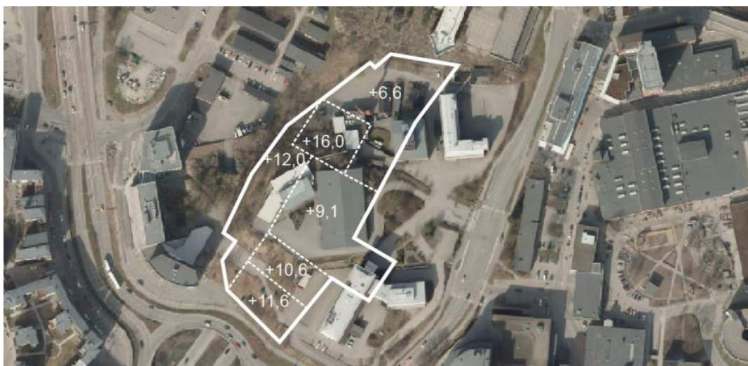
Figur 2 Schaktbegränsningar för Trafikverkets anläggningar enligt planbeskrivning (samrådshandling) enligt gammalt höjdsystem. +6,6 blir i RH00 +7,1. Bild: Nacka kommun
